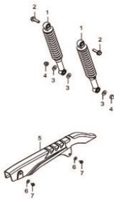
Fig.47 AMORTECEDOR TRASEIRO (X01-C450-0003) REF.No.
